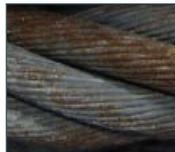
m Concentrazione di fili spezzati: 3 fili adiacenti spezzati nella parte esterna di un trefolo.
