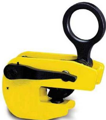
La pinza modello TTG è adatta a trasportare in orizzontale travi, lamiera, profilati ecc. Grazie alla posizione sfalsata dell'anello di aggancio, viene garantita la posizione orizzontale delle ali travi durante il trasporto. Il sistema di bloccaggio delle pinze TTG garantisce la completa sicurezza anche prima di iniziare il sollevamento. Questo permette all'operatore di posizionare la pinza, chiuderla ed allontanarsi dal carico.
