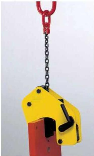
Le pinze TSB hanno ganasce a facce parallele per distribuire meglio la forza di serraggio su superfici di dimensioni maggiori. Le pinze TSB sono adatte al trasporto di materiali con superfici delicate. La protezione "Bremsit" offre un' eccezionale coefficiente di attrito, aumentando la presa delle ganasce.
