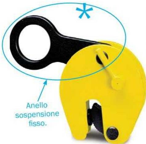
La pinza modello TTR è adatta per il trasporto, l'introduzione, l'estrazione e l'accatastamento di travi. L'anello di aggancio viene a trovarsi in corrispondenza del baricentro della trave. Si ottiene così la posizione verticale delle ali delle travi. Il sistema di bloccaggio delle pinze TTR garantisce la completa sicurezza anche prima di iniziare il sollevamento. Questo permette all'operatore di posizionare la pinza, chiuderla ed allontanarsi dal carico.
